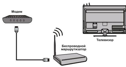
Встроенный модуль беспроводной связи
