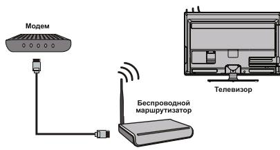
Встроенный модуль беспроводной связи
